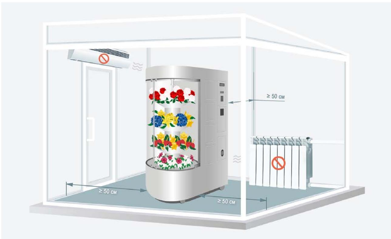
Схема установки автомата в помещении
