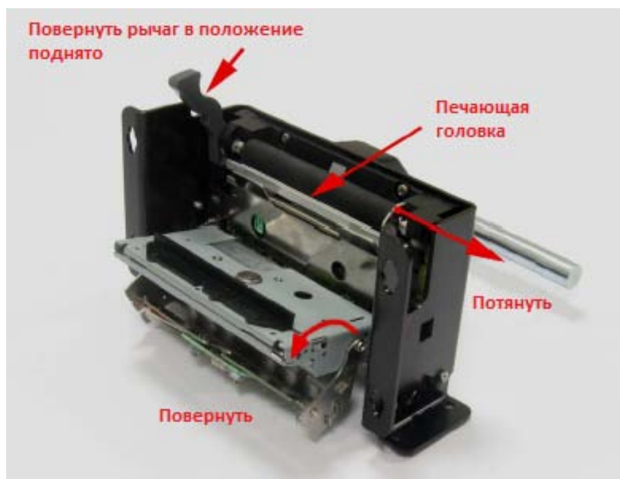
Рис. 13. Устранение замятия бумаги.
